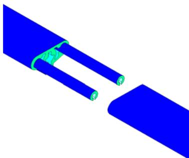
Innenhüllenfallen in der Seitenwand durch seitliches Verschieben der Innenhülle korrigieren. Bei gutem Sitz Handlauf durch Schläge mit der flachen Hand oder mit einem Gummihammer komplett aufdrücken.
