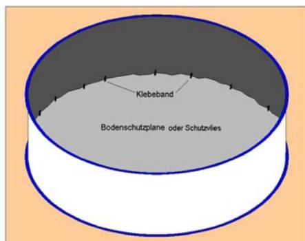
Boden nochmals gründlich reinigen, Schutzvlies auslegen, einzelne Bahnen auf Stoß legen. Schneiden Sie die Bodenschutzplane oder das Schutzvlies ca. 5 – 10 cm größer als die Beckenform zu und kleben Sie den entstehenden Überstand an der Stahlwand fest. (Ränder über die Bodenschienen ziehen. Verwenden Sie hierzu PVC-verträgliches Klebeband (z.B. Paketband). Bodenschutzplane oder Schutzvlies glatt und faltenfrei auslegen.
